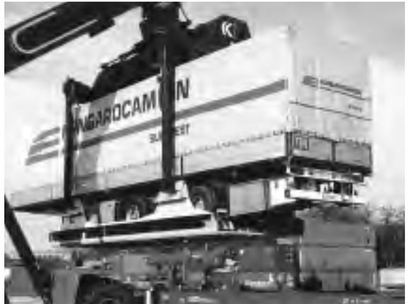
*Ungarischer Korbwagen Mitte der 90er - ermöglicht vertikalen Umschlag nicht kranbarer Sattelanhänger*
