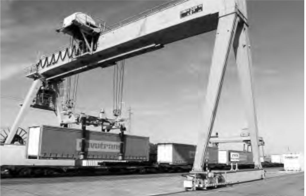
*Umschlag eines Wechselbehälters bei Novatrans, Frankreich*
