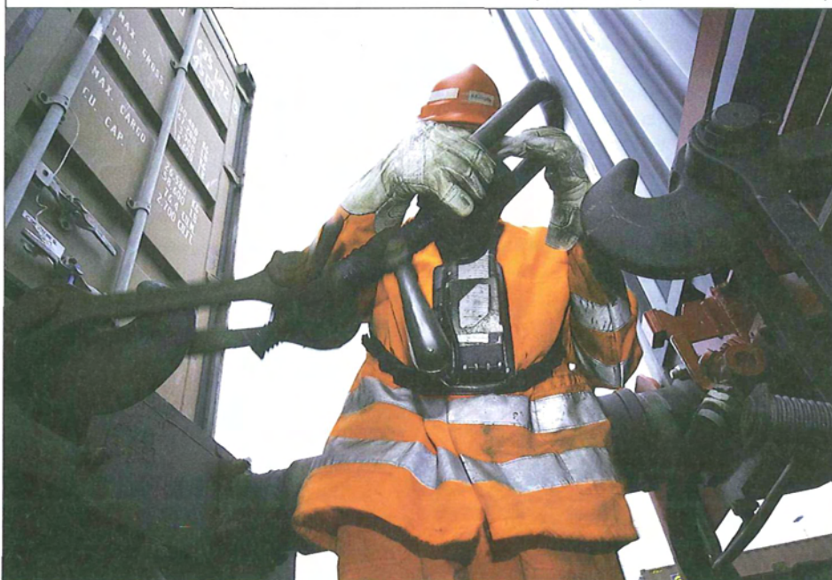
BILD 1: Veraltete Technik Schraubenkupplung: viel manueller Aufwand (Foto: DB AG/Heiner Müller-Elsner)
