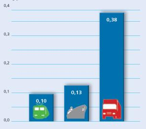
Spezifischer Energieverbrauch seit 2000; in Prozent; Bahn, Lkw, Schiff
