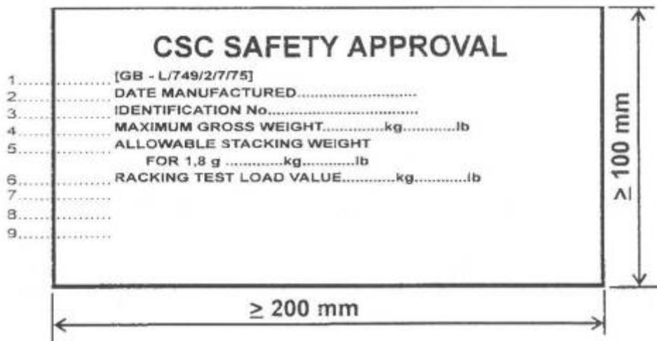
**Figure 8.10.7-4** Plaque d'homologation de la sécurité sur un conteneur
