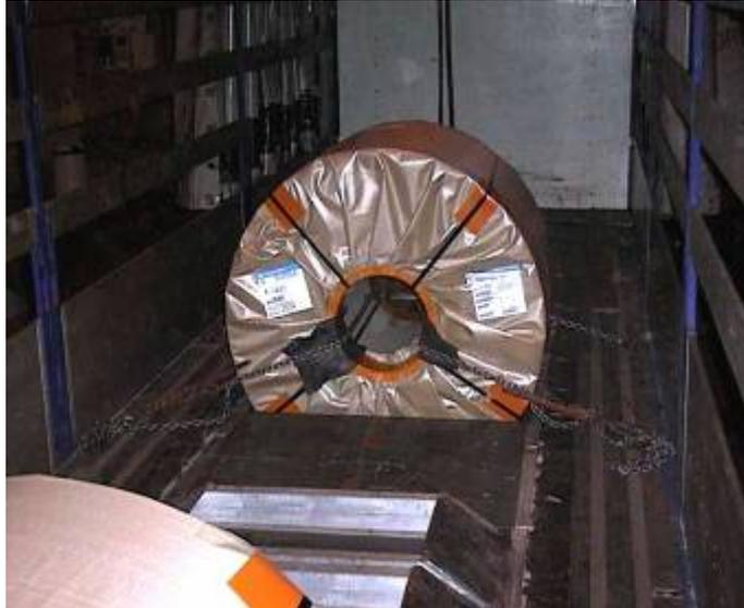
**Aucun espace vide n'est autorisé entre l'avant de la bobine et le panneau; les panneaux doivent être disposés de telle sorte que la bobine ne puisse se déplacer vers l'avant.**
