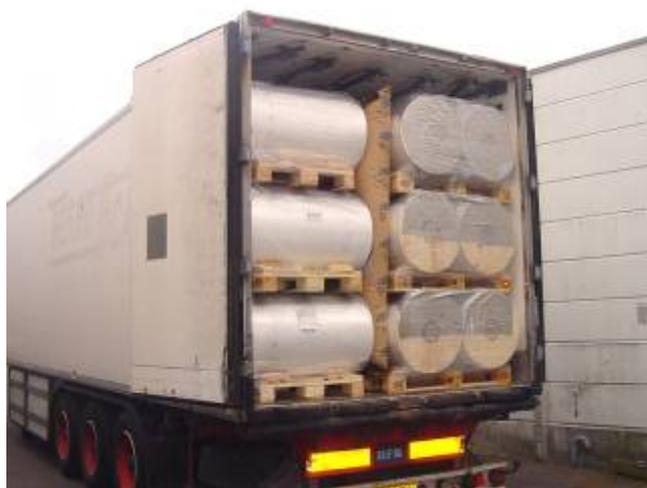
*Figure 18: Matériel de remplissage entre les rangées d'un chargement*
