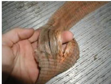
*Figure 36: Sangle très endommagée? Mettez-la au rebut!*
