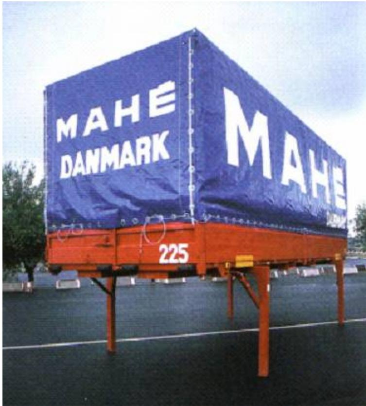
*Figure 16: Caisse mobile sur béquilles*
