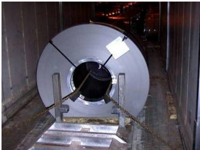
**Utilisez un croisillonement (transversal) pour éviter tout mouvement vers l'avant. Le croisillonement (transversal) ne peut déformer la bobine. Il convient dès lors de le protéger au niveau de la surface de contact avec, par exemple, des tissus en fibres synthétiques.**
