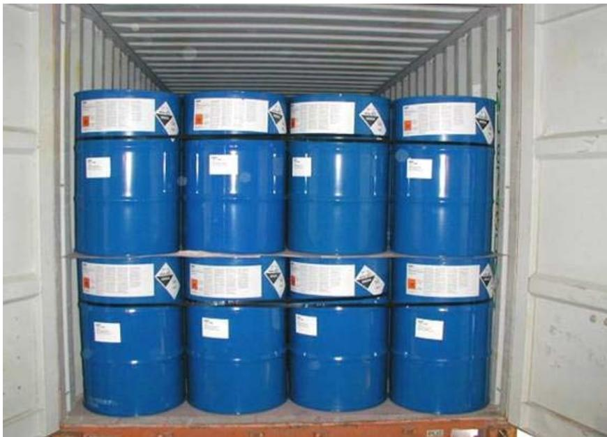
Tonneaux en acier, empilés par deux dans un arrimage en bloc et maintenus à l'aide de sangles fixées au châssis du conteneur.
