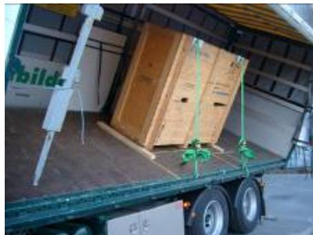
L'efficacité du dispositif d'arrimage d'un échangeur thermique est testée sur le plan de l'accélération avant et latérale.
