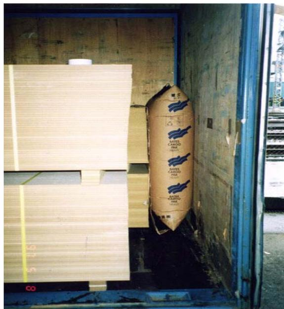
Figure 19: Coussin d'air dans une semi-remorque
