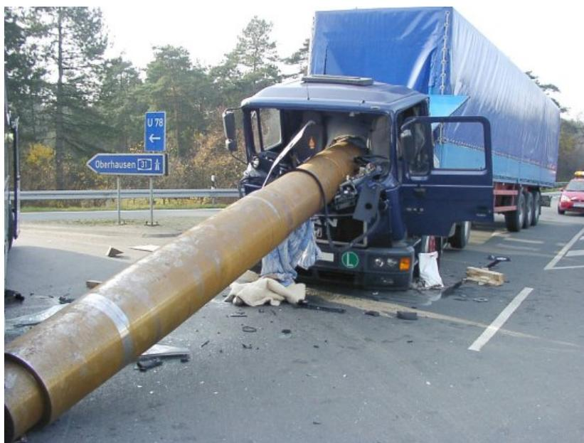
Figure 1: Lors d'un freinage brusque, les tubes d'acier mal fixés ont traversé le hayon et la cabine du conducteur.
