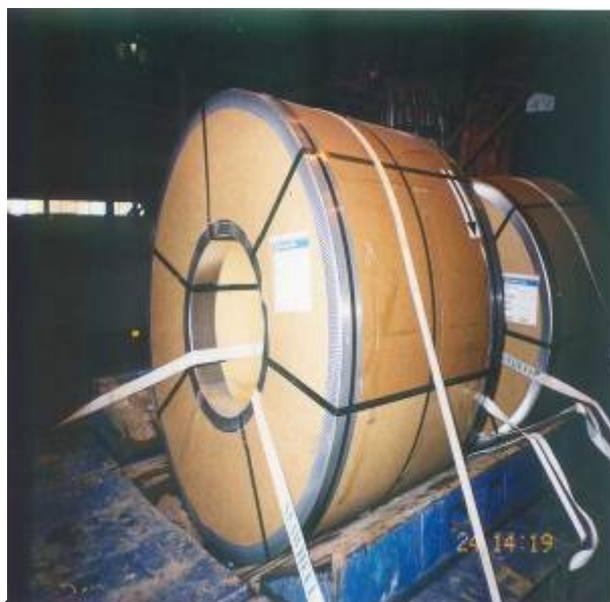
Sangles traversant et recouvrant la bobine
