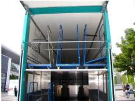
Figure 64: Palette à roulettes avec supports latéraux et barres de fixation
