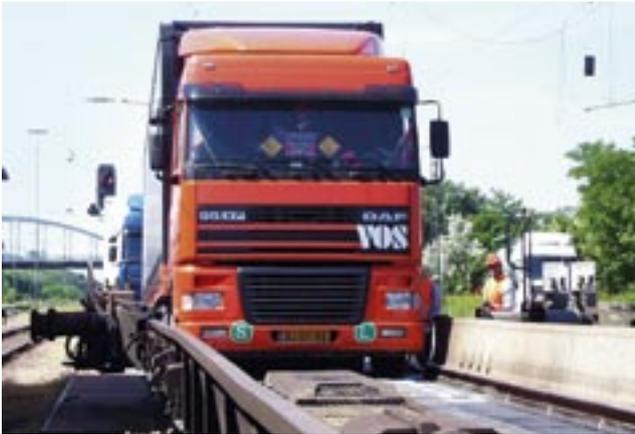
L'entreprise RAlpin AG a été fondée en avril 2001 par les trois sociétés BLS Lötschbergbahn AG, Hupac SA et SBB Cargo AG. L'offre de services reliant les terminaux de Fribourg en Brisgau et Novare permet aujourd'hui de transporter par le rail des camions d'une hauteur aux coins de 4 m, d'une largeur de 2,50 m et d'un poids total de 44 t à travers la Suisse.
