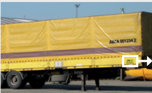
► Nuevas placas de codificación conformes a la norma EN13044 para cajas móviles y semirremolques (horizontal o vertical, según la preferencia).
