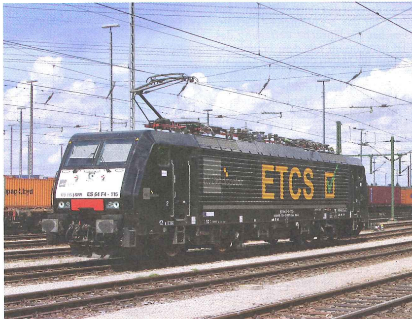
Diese Mietlokomotive von MRCE Dispolok ist schon für den Einsatz auf Strecken vorbereitet, die mit der Leit- und Sicherungstechnik ERTMS/ETCS ausgerüstet sind.
