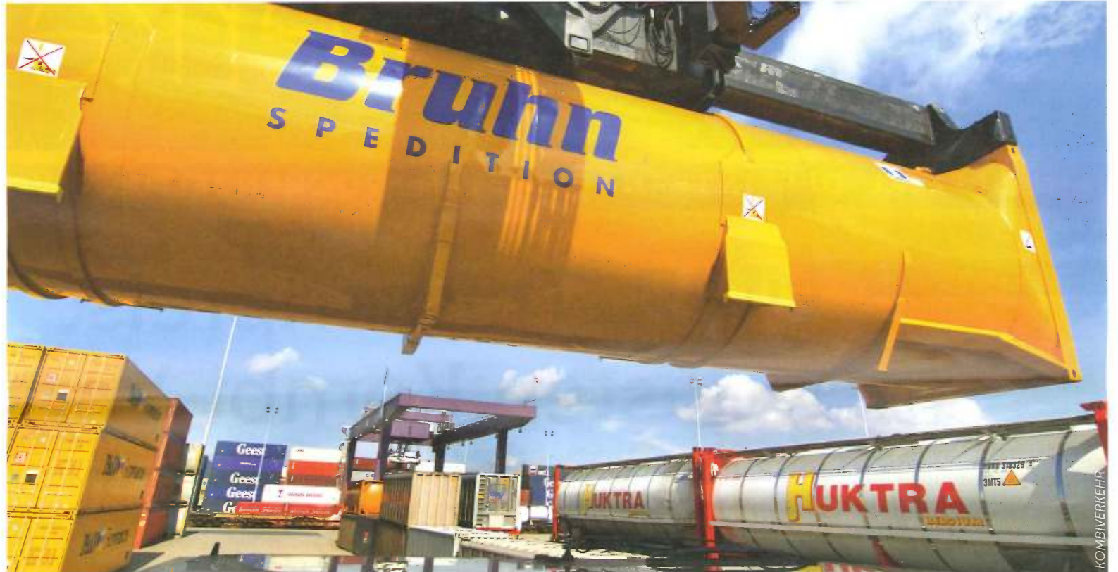
Kranung eines Tankcontainers, Kombiverkehr, Terminal Duisburg-Ruhrort Hafen
