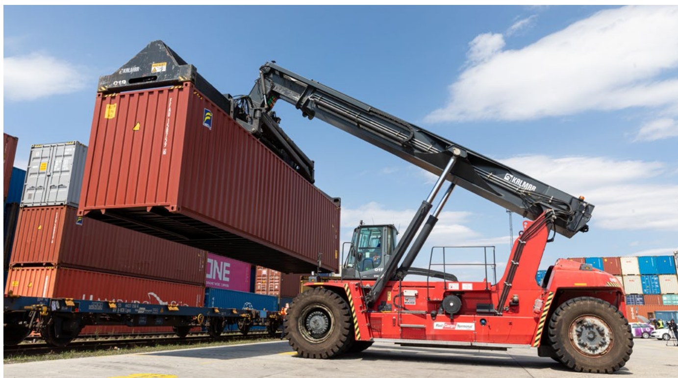
Abb. 2: Containerverladung mittels Reach-Stacker
