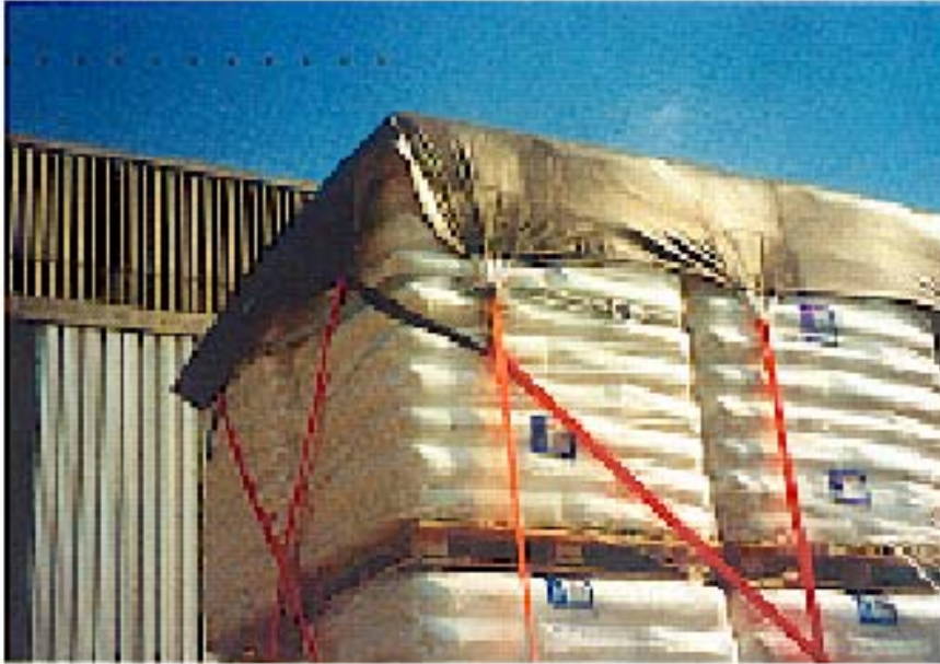
42. ábra: Takaróponyva kötözéssel
