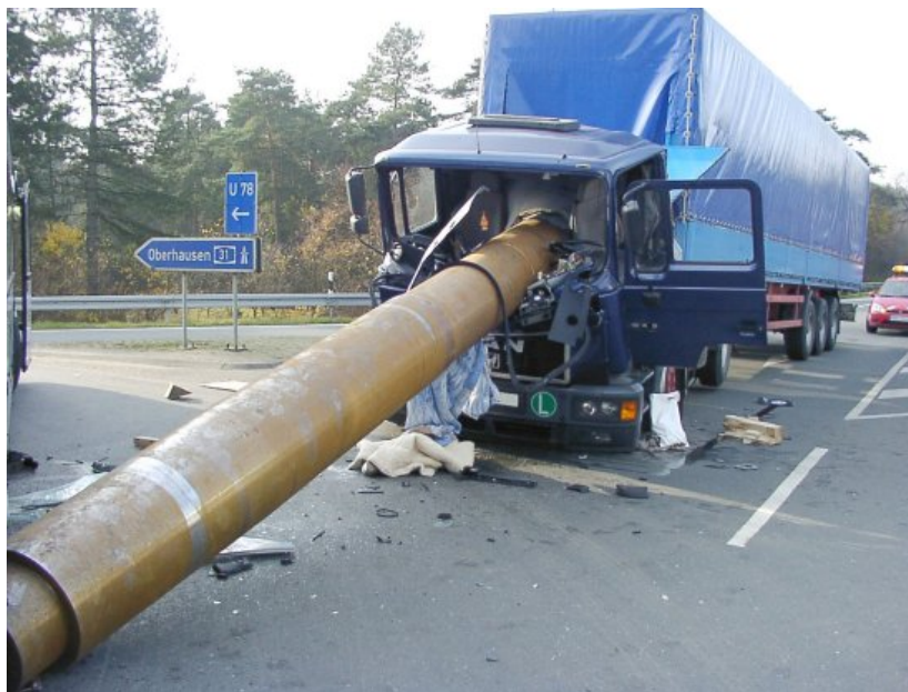
1. ábra: Erős fékezéskor az elégtelenül rögzített acélcsövek áthatoltak a homlokfalon és a vezetőfülkén.
