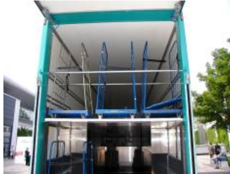
64. ábra: Görgős rakodólap oldaltartókkal és szorítórudakkal
