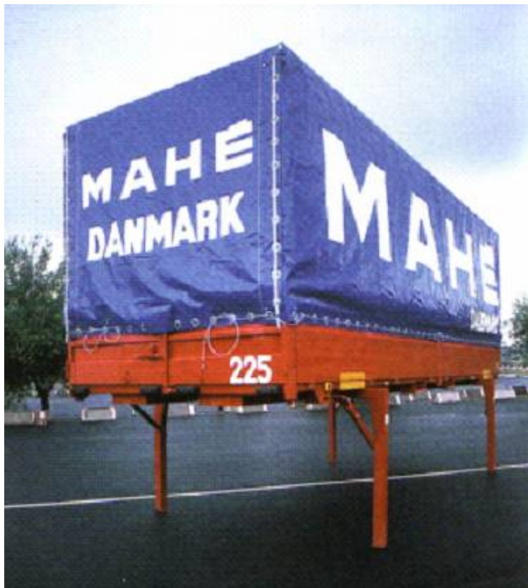
16. kép: Támasztólábakon álló cserefelépítmény
