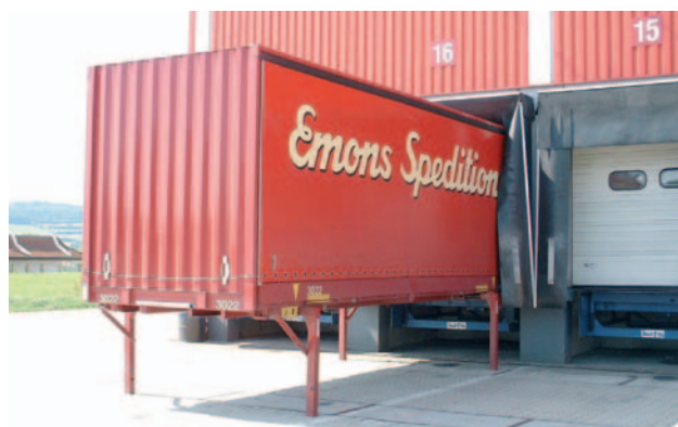
Caisse mobile à la rampe de chargement
