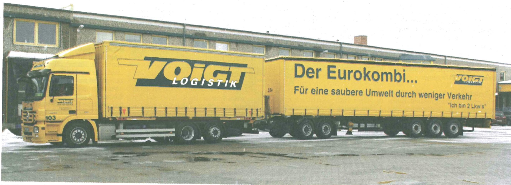
Die Länge macht es: Die Spedition Voigt setzt zwei 25,25 m lange Lastzüge in Pendelverkehren für zwei Großkunden in Schleswig-Holstein ein.
