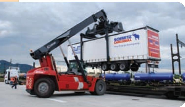
Transportiert werden kranbare Sattelaufleger (auch Megatrailer), Wechselbehälter, Tank- und ISO-Container.
