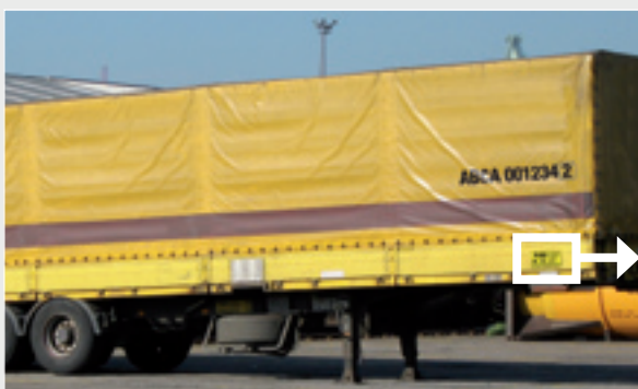
► Az EN13044 szabvány szerinti új kodifikáció táblák csereszekrényekhez és félpótkocsikhoz (mindkettő tetszés szerint vízszintes és függőleges kivételben)
