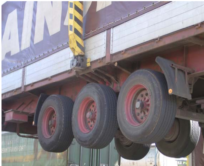
Transport von Sattelanhängern in Taschenwagen da das Lichtraumprofil beschränkt ist
