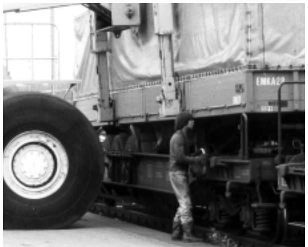
Arretierung des beweglichen Stützbocks in Köln.
