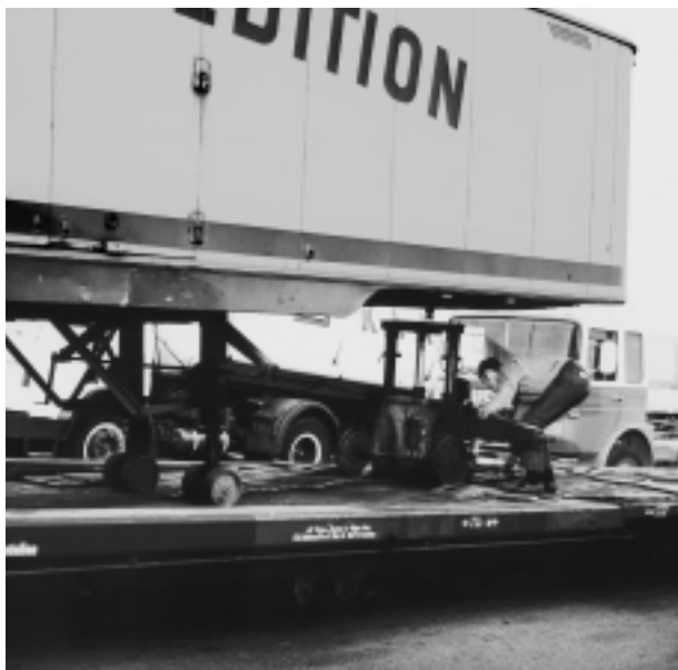
Ein Sattelanhänger wird in Hamburg mit Hilfe des mobilen Stützbocks auf einen Wippenwagen gefestigt.
