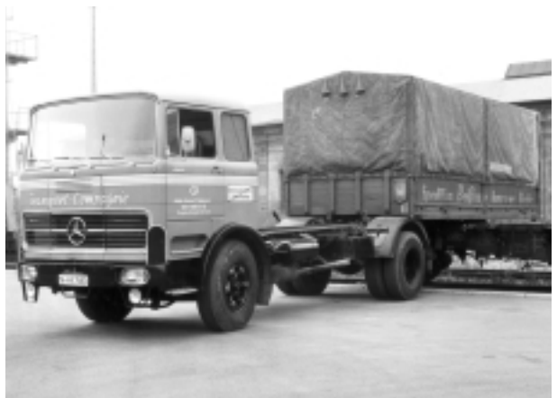
Horizontales Laden eines Wechselbehälters. Deutsche Versuchstechnik die 1970 dem vertikalen Umladen weichen mußte.
