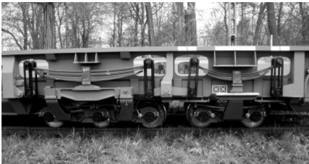
Das fünfachsiges Drehgestell der RoLa-Wagen von Ökombi im Einsatz ab 2001.
